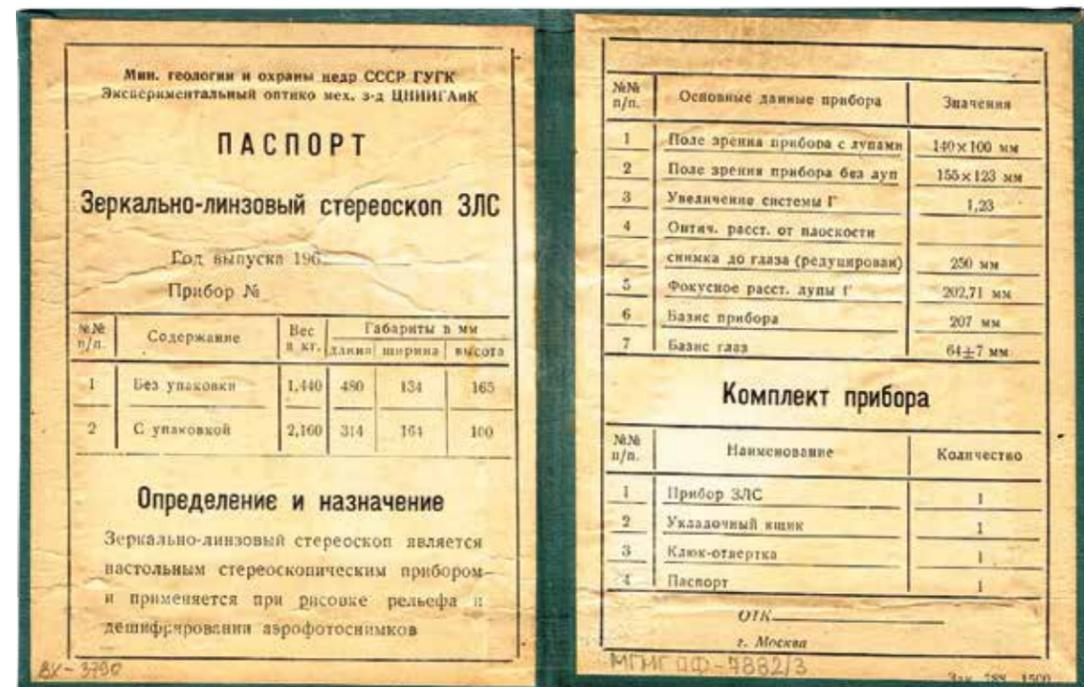
Является настольным стереоскопическим прибором и применяется при рисовке рельефа и дешифрирования аэрофотоснимков. Зеркально-линзовые стереоскопы рассчитаны на стереоскопическое изучение аэроснимков без измерительных операций. В стереоскопе зеркала и рамка для снимков являются подвижными и механически связанными так, что при передвижении рамки со снимками перпендикулярно к окулярам прибора происходит переключение оптических осей.
