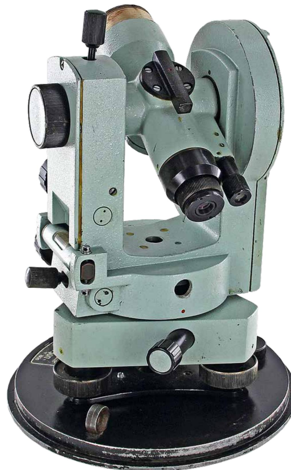
СКО измерения горизонтального угла из одного приема – 20"
