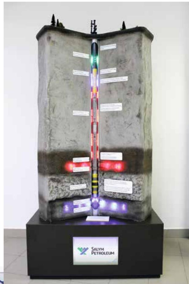
Макет фонтанной арматуры скважины, предназначенной для герметизации устья скважин, контроля и управления режимом эксплуатации. Образец представлен на выставке «Приобское: место рождения», организованной совместно с партнером музея – ООО «Газпромнефть-Хантос». Музей геологии, нефти и газа, Ханты-Мансийск
