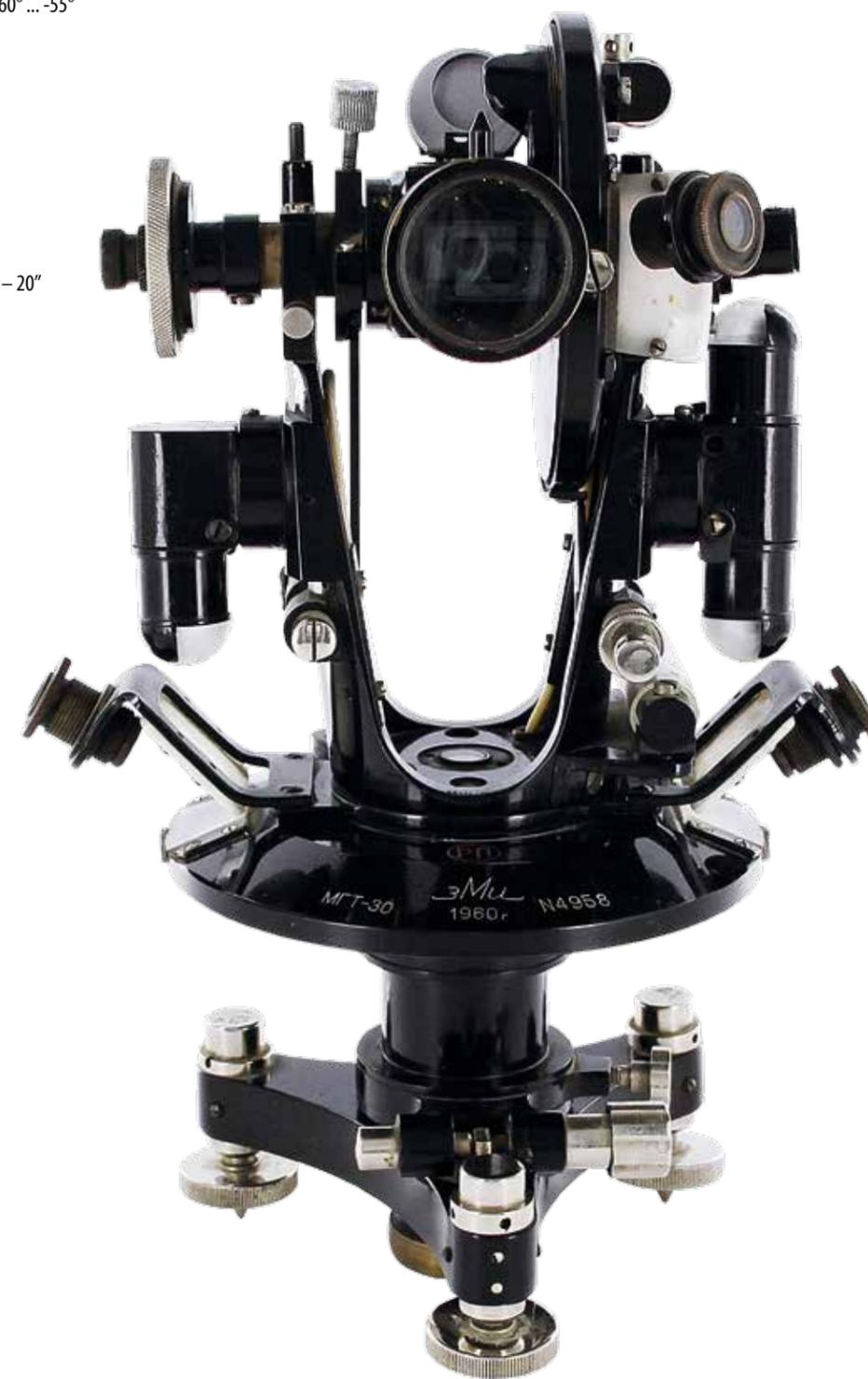
Малый горный теодолит 30-секундной точности. Оптический малогабаритный технический инструмент повторительного типа. Масс-габаритные характеристики полностью оправдывали название и позволяли устанавливать его на длинной консоли, прикрепленной к стенке горной выработки.
