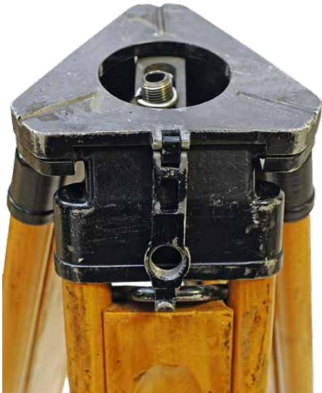
Профессиональный геодезический деревянный штатив ШР-160. Подходит для всех геодезических инструментов. Состоит из штативной площадки треугольной формы и трех раздвижных деревянных опор (ножек). По центру штативной площадки (головки) расположено круглое отверстие и становой винт для установки и закрепления геодезического прибора. Изготовлен из специально обработанной древесины, что делает его устойчивым для всех погодных условий.
