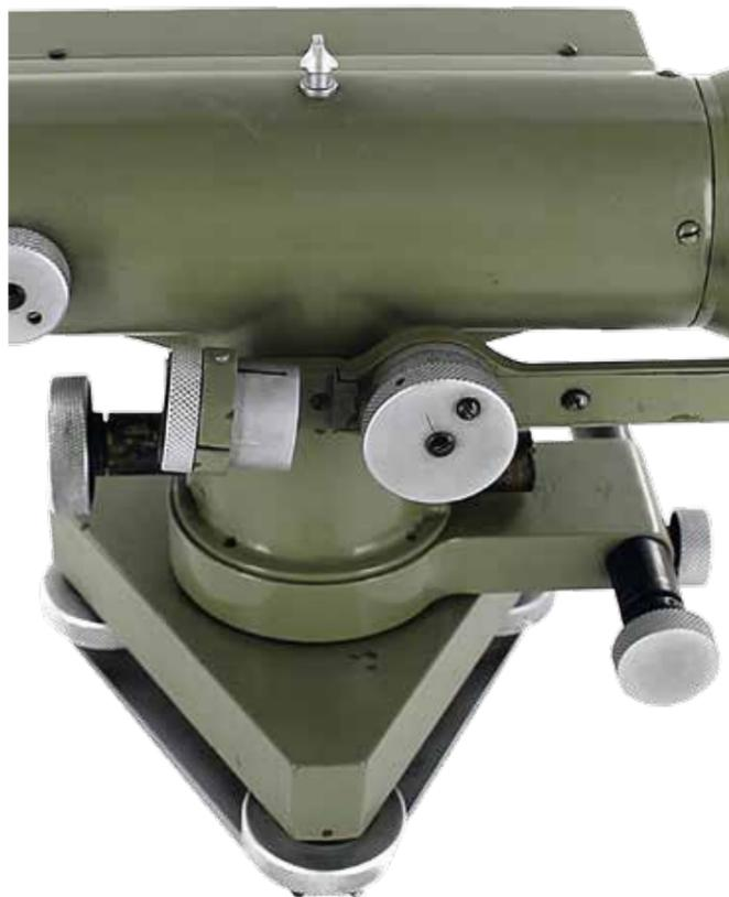
НПГ – оптический, высокоточный прецизионный глухой нивелир, предназначенный для нивелирования I и II классов. Характерной особенностью нивелира является то, что плоскопараллельная пластинка оптического микрометра помещена внутри трубы и с помощью зубчатых передач непосредственно связана с отсчетным микрометром. Благодаря этому была повышена надежность и точность работы отсчетного устройства, а, следовательно, и точность нивелира в целом.
