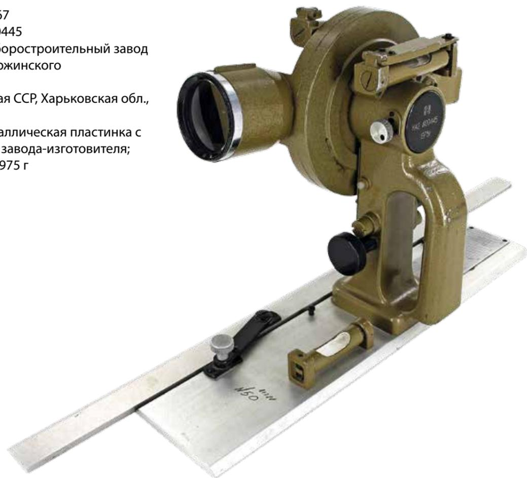
Кипрегель-автомат КА2 – усовершенствованный вариант кипрегеля КБ1. Особенность заключается в измененной схеме передачи изображения кривых диаграммы и деления круга в окуляр зрительной трубы.
