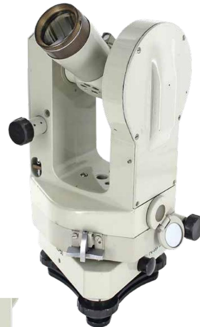
Малогабаритный, технический, оптический, маркшейдерский. Теодолит имеет прозрачные лимбы с поворотным горизонтальным кругом и двусторонним клиновым микрометром. Наличие встроенного оптического центрира позволяет работать по трехштативной системе, а с помощью нитяного дальномера зрительной трубы можно определять расстояния по нивелирной рейке. Предназначен для измерений горизонтальных и вертикальных углов при маркшейдерских работах в подземных горных выработках и на поверхности.
